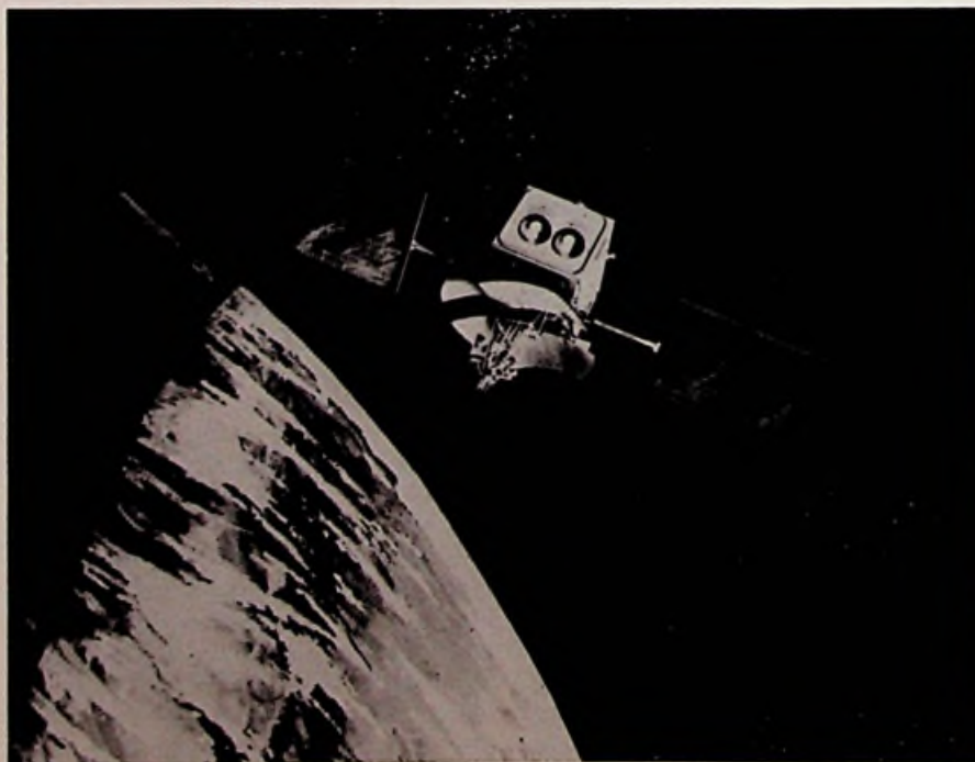
Bild 1. Zeichnung des SATCOM III mit voll entfalteten Solargeneratoren und An- tennen für horizontale und vertikale Polarisation (Bilder: RCA)
